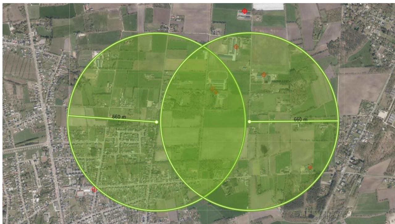
Figuur 18-6: Invloedstraal van bemaling ter hoogte van de fietstunnels
